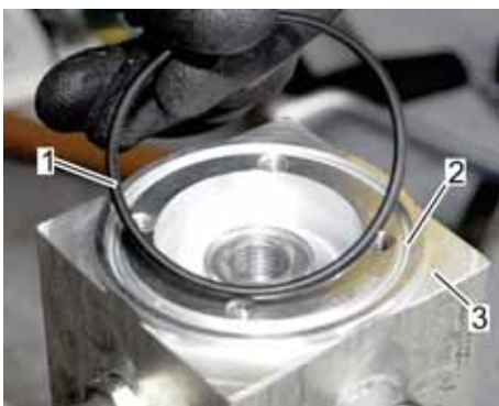
Abb. 41: O-Ring der Regelstufe abnehmen
