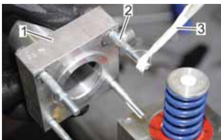
Abb. 101: Sechskantschrauben des Federdoms fetten
