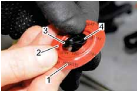
Abb. 69: Einknüpfdichtung in Sickenformmembran einlegen
