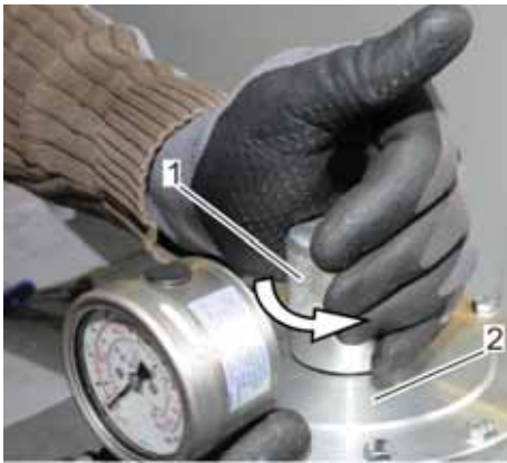
Abb. 29: Federdom der Regelstufe lösen
