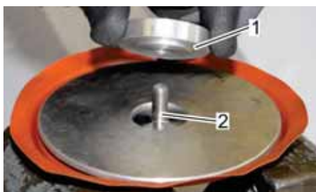
Abb. 47: Federteller auf Membranhalterung auflegen
