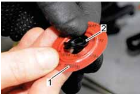
Abb. 67: Einknüpfdichtung aus Sickenformmembran entfernen
