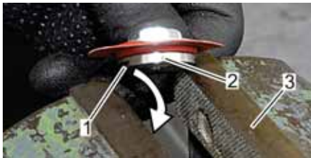
Abb. 64: Membranteller komplett einspannen
