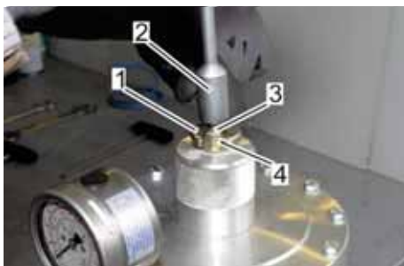
Abb. 28: Feder der Regelstufe entspannen
