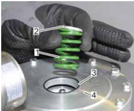
Abb. 30: Sollwertfeder mit Federteller entfernen
