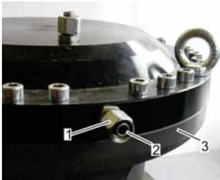
Abb. 10: Anschlussstutzen am Stellgerät fetten
