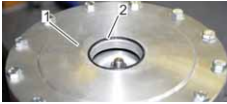
Abb. 125: O-Ring in Messwerkdeckel einlegen
