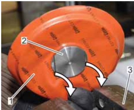
Abb. 42: Membranteller Regelstufe einspannen
