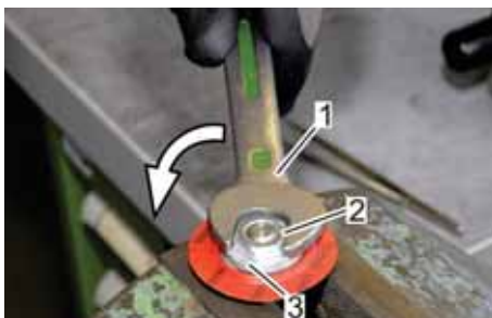
Abb. 65: Sechskantmutter von Membranhalterung lösen
