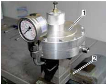
Abb. 27: Regler in Schraubstock spannen
