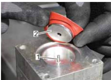
Abb. 56: Membranteller komplett abnehmen
