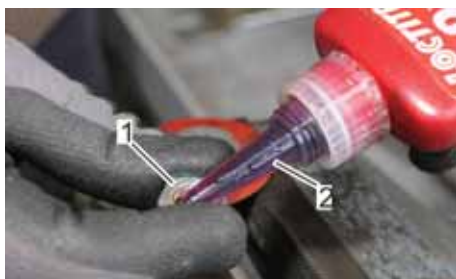
Abb. 73: Kleber auf Gewinde aufbringen
