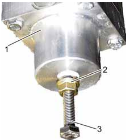
Abb. 23: Sollwertesteller der Hilfsdruckstufe bedienen
