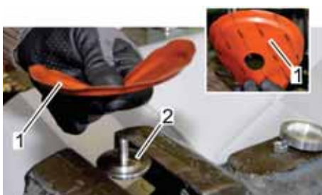
Abb. 45: Membran der Regelstufe auflegen
